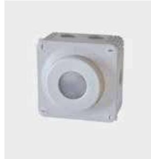
11.1801.3101.00 N Sensor inalámbrico para grandes alturas. Intensivo. Sensor inalámbrico wireless bluetooth de nivel de luz y presencia para grandes alturas de TROLL, con ángulo de captación intensivo. Permite activar luminarias de forma individual, en grupos o escenas al detectar presencia y/o regular su valor de luminosidad en función del aporte de luz natural y/o en función del ciclo circadiano. Tiene un ángulo de 360° que cubre 5 metros de diámetro, cuando se monta a 20m de altura.
