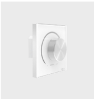
11.1801.1020.00 Panel con elemento rotativo para control 1-10V de TROLL. Accesorio diseñado para empotrarse en muro y capaz de controlar una corriente de hasta 50mA y conectar/desconectar una corriente max de 5 A. Se alimenta a tensión de red 220-240V y 50/60Hz.
