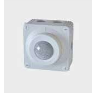
11.1801.3102.00 N Sensor inalámbrico para grandes alturas. Extensivo. Sensor inalámbrico wireless bluetooth de nivel de luz y presencia para grandes alturas de TROLL, con ángulo de captación extensivo. Permite activar luminarias de forma individual, en grupos o escenas al detectar presencia y/o regular su valor de luminosidad en función del aporte de luz natural y/o en función del ciclo circadiano. Tiene un ángulo de 360° que cubre 28 metros de diámetro, cuando se monta a 14m de altura.
