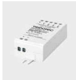
11.1801.5031.00 N Interfaz de comunicación wireless bluetooth para 4 salidas PWM de TROLL. Corriente de salida máx. 6 A (libre distribución en los canales). Establece automáticamente una red de comunicación inalámbrica con hasta 250 nodos. Puede controlarse mediante una app con dispositivos Android o iOS.
