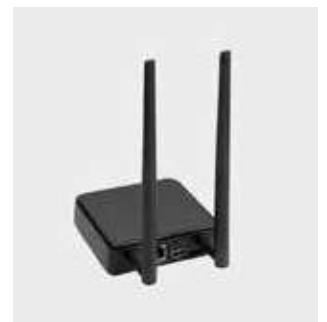
11.1801.8100.00 N Gateway de comunicación wireless bluetooth de TROLL. Permite el acceso remoto a una instalación. Para su puesta en marcha requiere una pantalla conectada por HDMI y una conexión inalámbrica fija para su acceso remoto en cualquier momento. Se accede al gateway por internet (WIFI, LAN o 4G). Soporta conexión a 2 redes wireless bluetooth simultáneamente.
